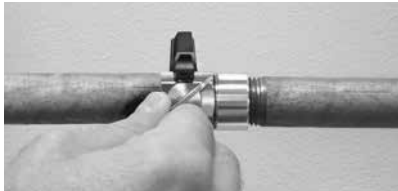
Filterdækslet åbnes med en mønt eller en skruetrækker
