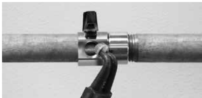
Filteret tages ud med en tang, og filteret renses eller udskiftes
