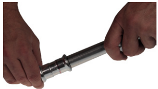
FIGUR 8: SAMLING AF FITTING/RØR
